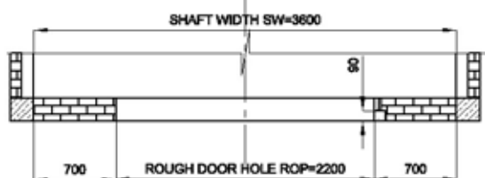
CỬA TẦNG KIỂU 4 CÁNH MỞ TRUNG TÂM (4CO) 4-LEAF CENTER OPENING LANDING DOOR
